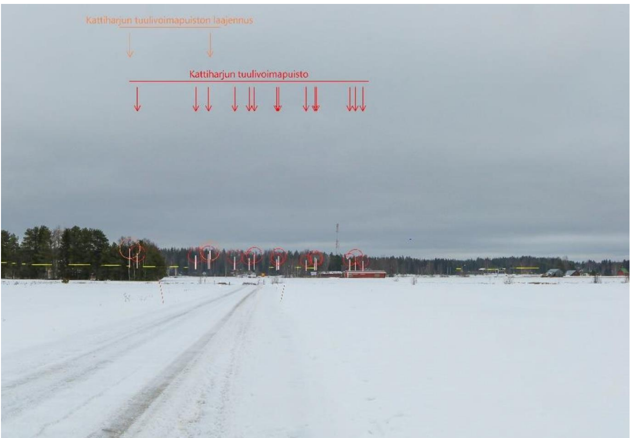
Kuva 55. Valokuvasevite kuvauspisteestä 4. Näkymä kohti tuulivoimaloita Hopantieltä, etäisyys lähimpään voimalaan noin 7,3 km. Kuva osoittaa, että voimaloiden lavat ovat havaittavissa puiden takaa, mutta muita rakenteita ei näy.
